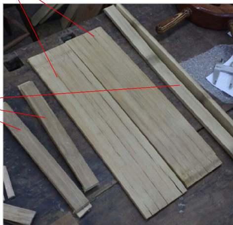
Figura 19: Ripas serradas e plainadas, colmo planificado e plainado/lixado. Fonte: Salamon
