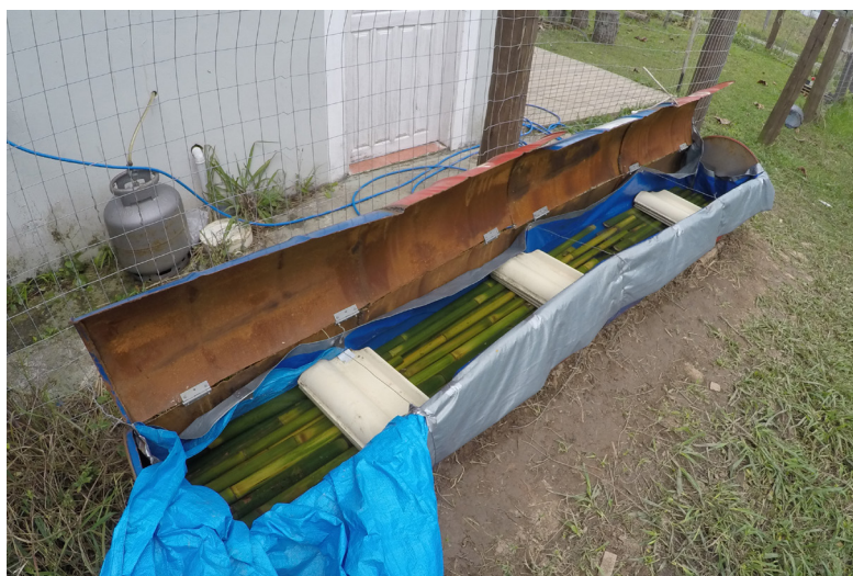
Figura 23: Tratamento por imersão em octaborato de sódio. Fonte: Vitor (2018)
