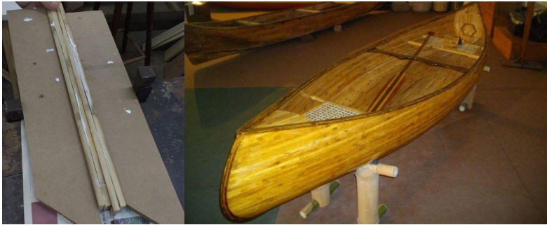
Figura 12: Ripas serradas, fresadas e plainadas. Canoa e remos confeccionados a partir de ripas de bambu com encaixe macho fêmea. Fonte: Marcelo Cadori.
