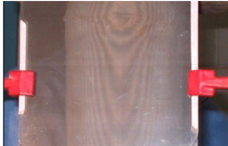
Figura 20: (A) Montagem experimental; (B) Franjas de Moiré. Foto: Beraldo.
