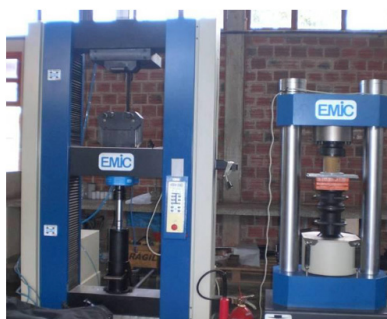
Figura 20: Máquina universal e prensa servo-hidráulica, utilizadas nos ensaios. Foto: Carbonari.
