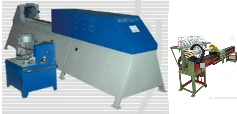
Figura 04: Faca de corte múltiplo mecanizada. Esquerda, acionamento hidráulico. Direita, acionamento por corrente. Fonte: Garnet Tools (esquerda); Henan Gelgoog (direita)
