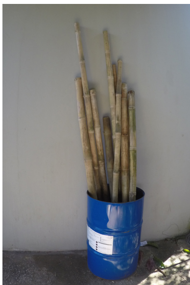
Figura 21: Preservação por inundação dos entrenós. Foto: Vitor (2018)
