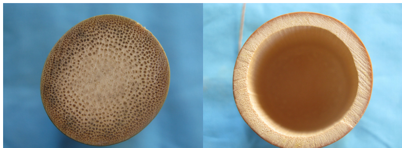
Figura 04: (A) T. siamensis – bambu maciço; (B) P. aurea – bambu oco. Fonte: Beraldo.
