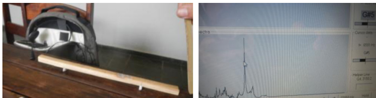
Figura 22: (A) Montagem experimental; (B) Resultado da frequência de ressonância. Foto: Beraldo.
