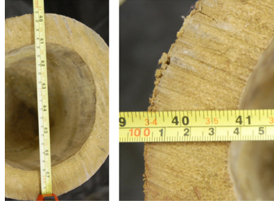
Figura 06: Colmo de D. asper na região da base, diâmetro 22 cm e espessura de parede 3,5 cm. Fotos: Ostapiv
