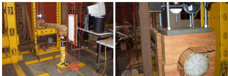
Figura 24: (A) Detalhes do ensaio de flexão estática para o colmo engastado-livre; (B) Detalhe do primeiro entrenó concretado junto ao engaste.
