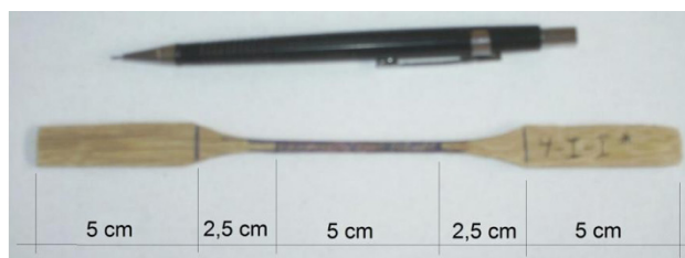
Figura 22: Corpo de prova de bambu utilizado nos ensaios de tração paralela às fibras. Foto: Carbonari.
