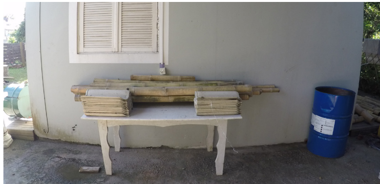
Figura 24: Secagem e estoque dos colmos de Dendrocalamus asper . Foto: Vitor (2018)
