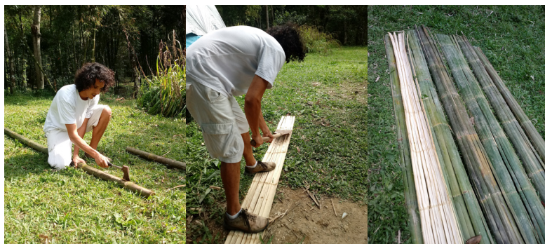
Figura 20: Processo de planificação do bambu. Foto: Vitor (2018)
