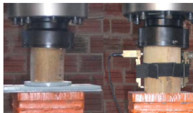
Figura 26: Detalhe do ensaio de módulo de elasticidade. Foto: Carbonari
