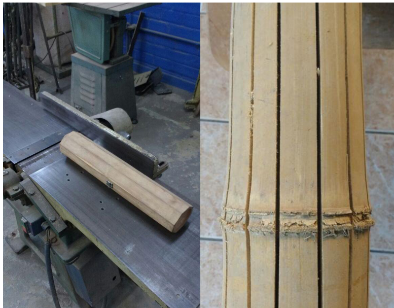
Figura 07: Protótipo de serra dupla desenvolvida com materiais reciclados e colmo serrado. Fonte: Salamon
