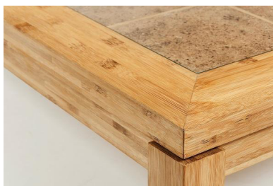
Figura 28: Mesa de centro em BLaC e aglomerado-detalle Fonte: Foto do acervo do Projeto Bambu, 2018
