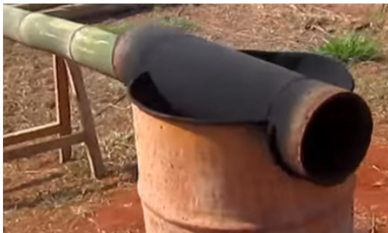
Figura 06: secagem ao fogo utilizando tonéis. Fonte: Tratamento de Bambu, Carpintaria Capiau. Tecnologia Caipira (2018)
