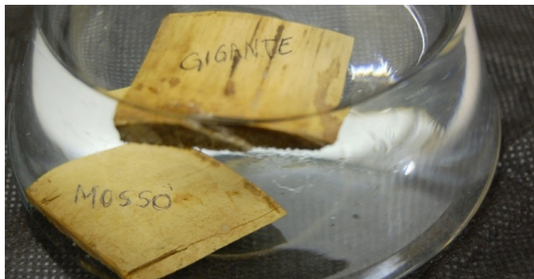
Figura 10: Corpos de prova da região da casca de colmos de bambu gigante e de mossô. Foto: Ostapiv
