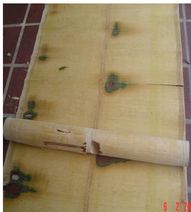
Figura 14: Lâminas obtidas por torneamento.
